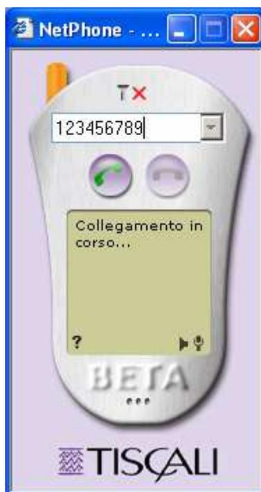
**Figura 52 – Tiscali NetPhone: permette di effettuare chiamate da PC a PC, da PC a rete telefonica e da rete telefonica a PC**
